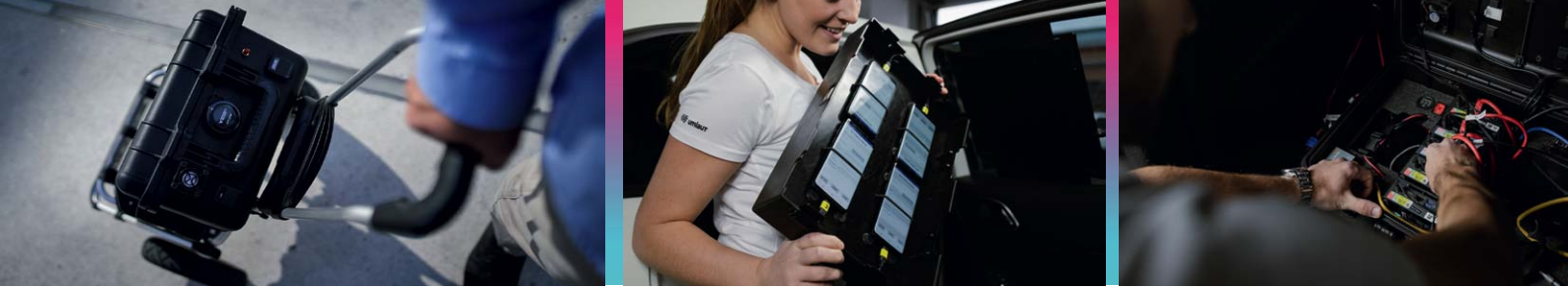
Jedes Drivetest-Auto transportierte neun Smartphones für die Sprach- und Datentests. Die Walktest-Teams hatten Trolleys, in denen starke Akkus die Smartphones speisten.
