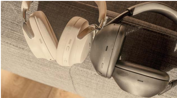
Beide Over-Ears haben noch Tasten. Beim Bose-Modell gibt es an der linken Ohrmuschel einen berührungsempfindlichen Streifen für die Steuerung der Lautstärke. Bei Sony steuert man die Musik komplett über die Touch-Flächen an den Ohrmuscheln.
