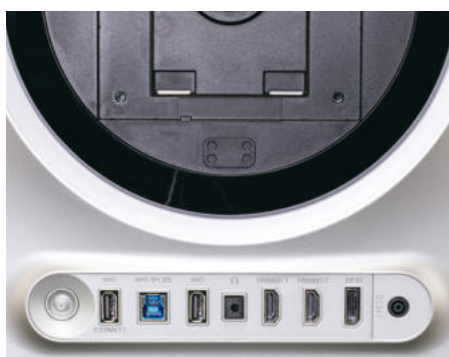
Schnittstellen: USB-Hub, Headset-Anschluss, 2x HDMI 2.1, DisplayPort 1.4, externe Stromversorgung.
