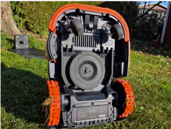
Der Mährteller hat sechs Klingen und 22 Zentimeter Schnittbreite. Den Antrieb übernimmt ein Motor mit bis zu 100 Watt.
