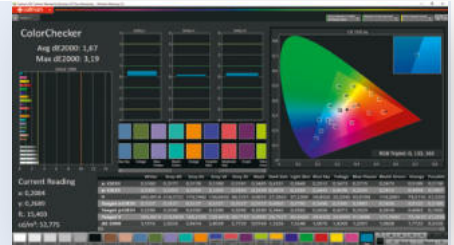
Hohe Bildqualität: Das QD-OLED-Panel des Acer Predator X27UX1 stellt im Test die Colorchecker-Referenzfarben sehr exakt dar.
