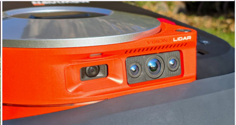
Die „Augen“ der H2-Serie: Eine Kamera mit 140-Grad-Sichtfeld wird von einem LiDAR-System flankiert.
