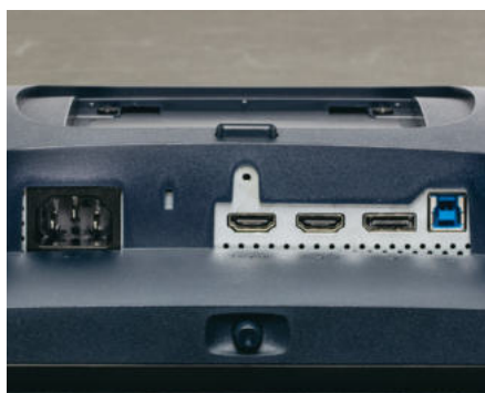
Schnittstellen: Interne Stromversorgung, 2x HDMI 2.1, DisplayPort 1.4, USB-Hub mit zwei Downstream-Ports.
