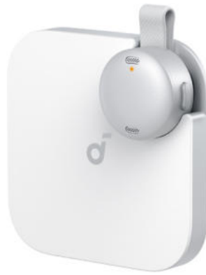
Das Diktiergerät dockt magnetisch am Case an. Das hält Akkureserven bereit, LED-Punkte geben Aufschluss über den Ladestand.
