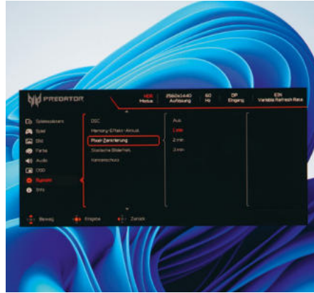
Die integrierten Schutzfunktionen Ihres OLED-Monitors sollten Sie keinesfalls deaktivieren. Bei AOC (links) sind die Einstellungen unter Pixel Orbiting zu finden, bei Acer (rechts) unter Pixel-Zentrierung.
