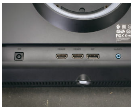
Schnittstellen: Externe Stromversorgung, 2x HDMI 2.1, DisplayPort 1.4, Headset-Anschluss.
