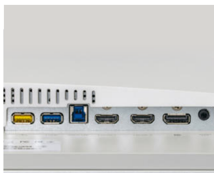
Schnittstellen: USB-Hub mit zwei Downstream-Ports, 2x HDMI 2.1, DP 1.4, Headset-Anschluss.
