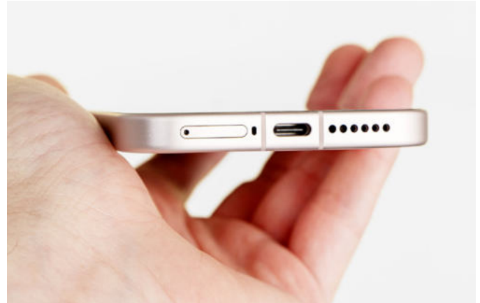
Der USB-C-Port des Xiaomi 17 unterstützt den schnellen 3.2-Standard.
