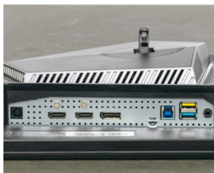
Schnittstellen: Externe Stromversorgung, 2x HDMI 2.1, DisplayPort 2.1, USB-Hub, Headset-Anschluss.
