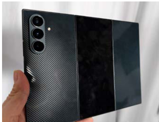
Die Rückseite besteht aus Keramikglas, das leider nicht mattiert ist. Die Hochglanzoberfläche zieht Fingerabdrücke an.
