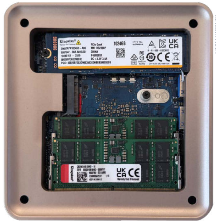
Oben ist die SSD von Kingston zu sehen, direkt darunter befindet sich der leere M.2-2242-Slot unseres Testrechners. Ganz unten im Bild die beiden RAM-Module.
