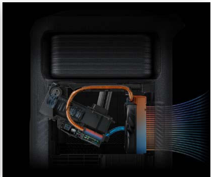
Die nach oben gerichtete Projektionseinheit mit rückwärtiger Ablüftung.
