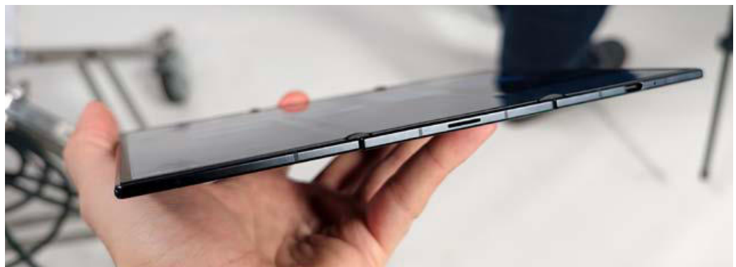
Aufgeklappt misst das Gerät nur 3,9 bis 4,2 Millimeter und wirkt dabei tabletartig schlank.
