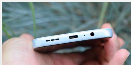
Der leicht gewölbte Rahmen liegt angenehm in der Hand. Auf der Unterseite ist neben dem Lautsprecher und der USB-C-Buchse auch eine Klinkenbuche positioniert.
