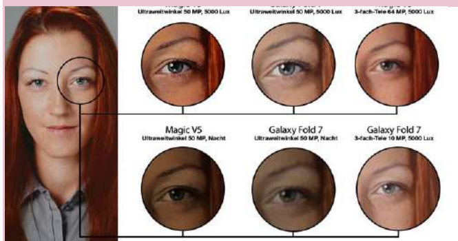
Die Ultraweitwinkelkamera des Magic V5 liefert eine deutlich bessere Qualität bei Tag und im Dunkeln als jene des Galaxy Fold 7. Durch die hohe Auflösung hat Honor auch beim Tele einen Vorsprung.
