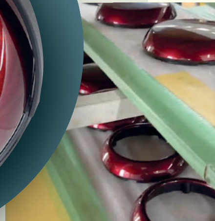
Das Verfahren der Urushi-Lackierung basiert auf dem natürlichen Harz des Lackbaums.
