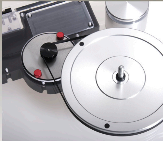
Im Takumi TT level 1.1 dreht ein Wechselstrommotor den Aluminium-Subteller über Flachriemen an. Die roten Transportsicherungsschrauben bitte lösen!
