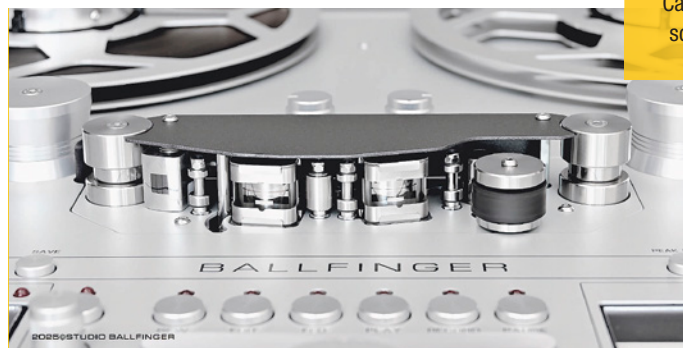
Die drei Tonköpfe bei Ballfinger ermöglichen echte Hinterband-Kontrolle noch während der Aufnahme.
