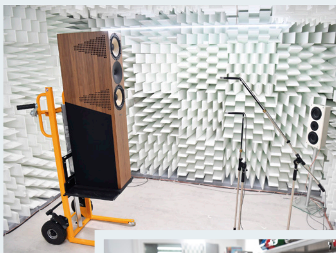
Lautsprecher werden unter definierten Laborbedingungen in einem reflexionsarmen Halbraum gemessen. Für optimale Ergebnisse kombiniert eine über viele Jahre verfeinerte Routine verschiedene Verfahren wie Freifeld-, Nahfeld- und Groundplane-Messungen.
