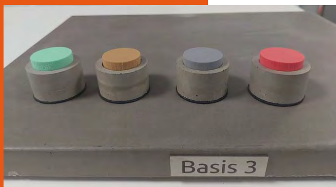
Ob Platte oder Fuß mit Sylo-Schaumstoffkern, die Absorber-Elemente sind aus Beton.
