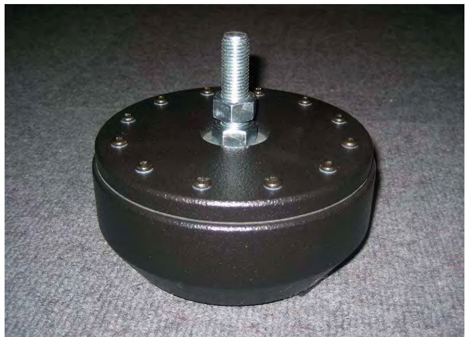
Die Schwingungsdämpfer bilden ein bedämpftes Federsystem und wiegen bereits selbst mehrere Kilo. Je nach Last sind drei oder sogar vier der Elemente unter einem superschweren Rack möglich.
