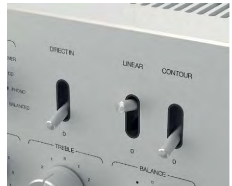
Der Linear-Schalter deaktiviert die Klang- und Balance-Regelung. Es gibt auch eine Loudness.
