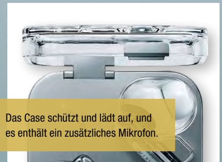
Das „Super Mic“ wird aktiv, wenn man beim Telefonieren die „Talk“-Taste drückt.
