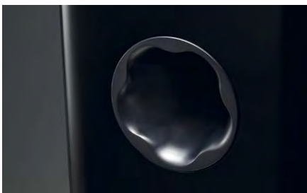
Der Twisted Flare Port reduziert Strömungsgeräusche und soll präzisen, straffen Bass liefern.
